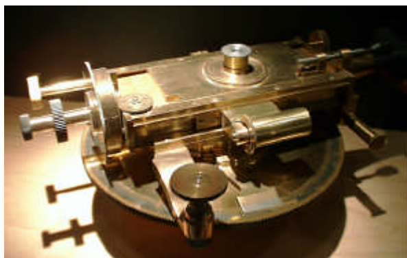
Figura 2. Micrómetro filar construido por Warner & Swasey alrededor de 1900.
