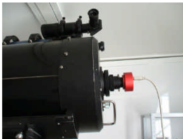
La cámara Luna QHY-Color acoplada al C11
