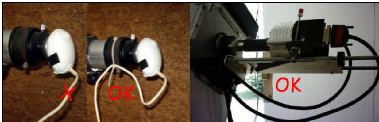
Fig. 3 : Ejemplos de fijación de una cámara.
