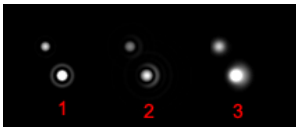
Fig 2: Efecto de una mala colimación: a la izquierda la imagen es perfecta. En medio vemos los efectos de una colimación incorrecta, el primer anillo de la estrella principal es muy visible. A la derecha, con un tiempo de exposición un poco más largo, la imagen de la componente principal está saturada y su fotocentro aparece descentrado. El efecto no se hace sentir sobre la compañera. ¡La diferencia en theta entre la primera y la última imagen es de 2°!
