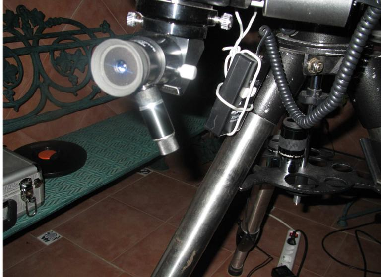
Figura 10. Instalación del ocular micrométrico comercial.
