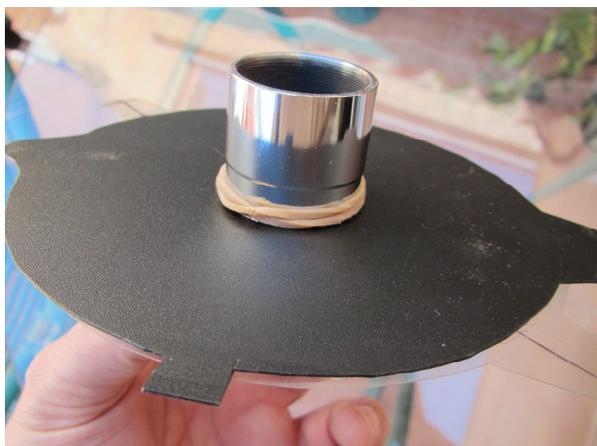
**Figura 5 (arriba):** Portabilidad de los medios usados y **Figura 6 (abajo):** Fijación del círculo graduado al barrilete del ocular.
