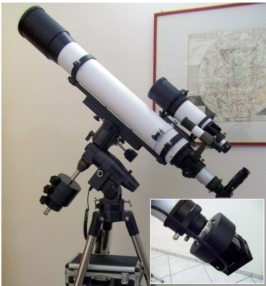
**Figura 4.** El refractor ED 127 f/9 usado en este trabajo. **Figura 5 (recuadro interior).** Cámara CMOS 1280x960 totalmente de fabricación propia.
