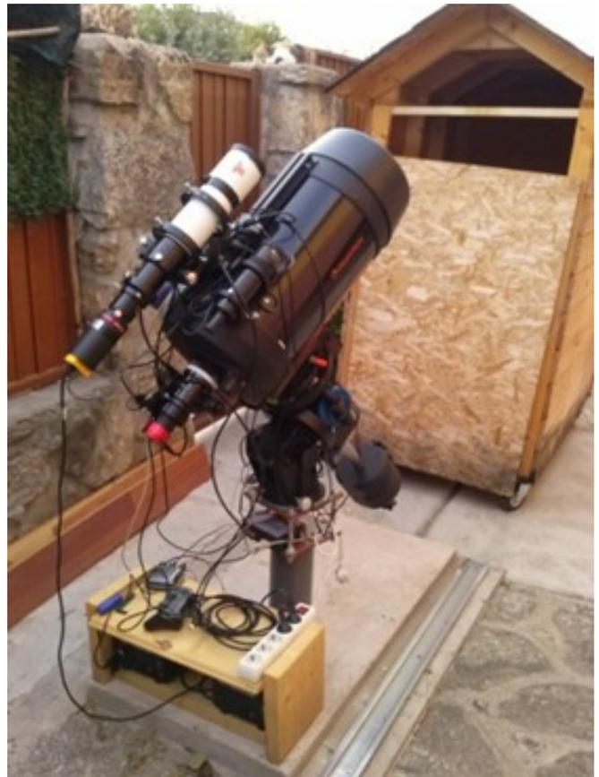
**Figura 1.** En esta reciente fotografía, se ha cambiado la cámara Atik 383L por una ASI1600MM sin rueda de filtros y sin refrigeración.
