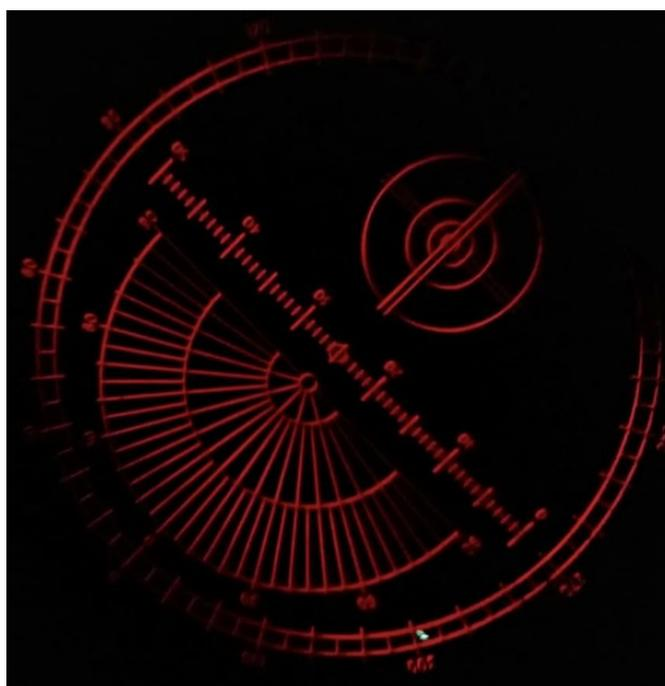
**Figura 6.** Ángulo de posición AB-C: cada espacio son  $5^\circ$ . Nos marca aproximadamente  $297^\circ$ . Debido a las inversiones de imagen provocadas por los espejos del tren óptico utilizado, para obtener la medición real hay que hacer la siguiente operación:  $360^\circ - 297^\circ = 63^\circ$ .
