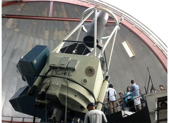
Figura 1. Telescopio Perkin-Elmes de 1,6 metros usado recientemente en un trabajo para encontrar compañeras físicas alrededor de estrellas *Be*. Crédito: [https://commons.wikimedia.org/wiki/File:Telesc%C3%B3pio\\_de\\_1,6\\_m..jpg](https://commons.wikimedia.org/wiki/File:Telesc%C3%B3pio_de_1,6_m..jpg).
