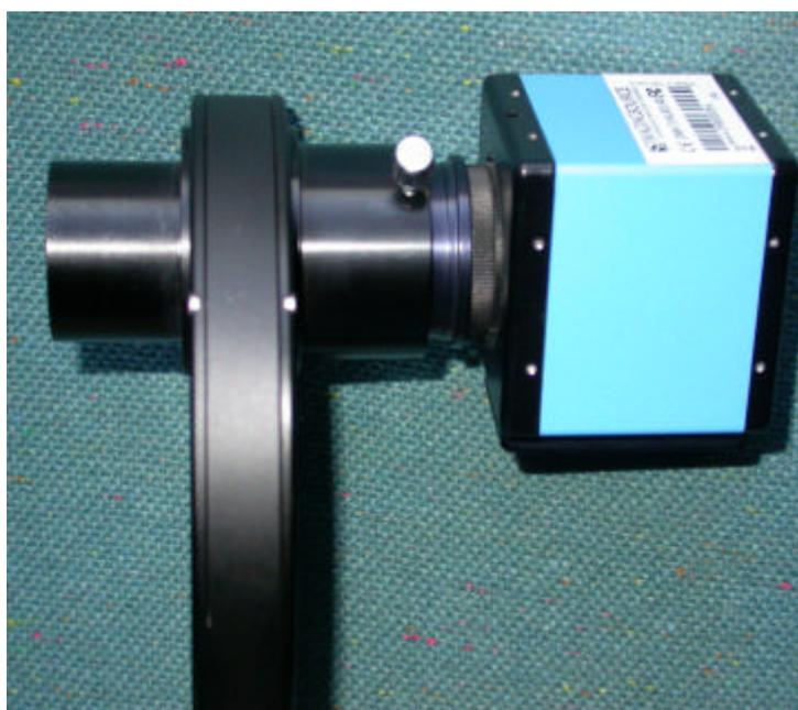
Figura 5. Montaje de la DMK con la rueda portafiltros de Atik.
