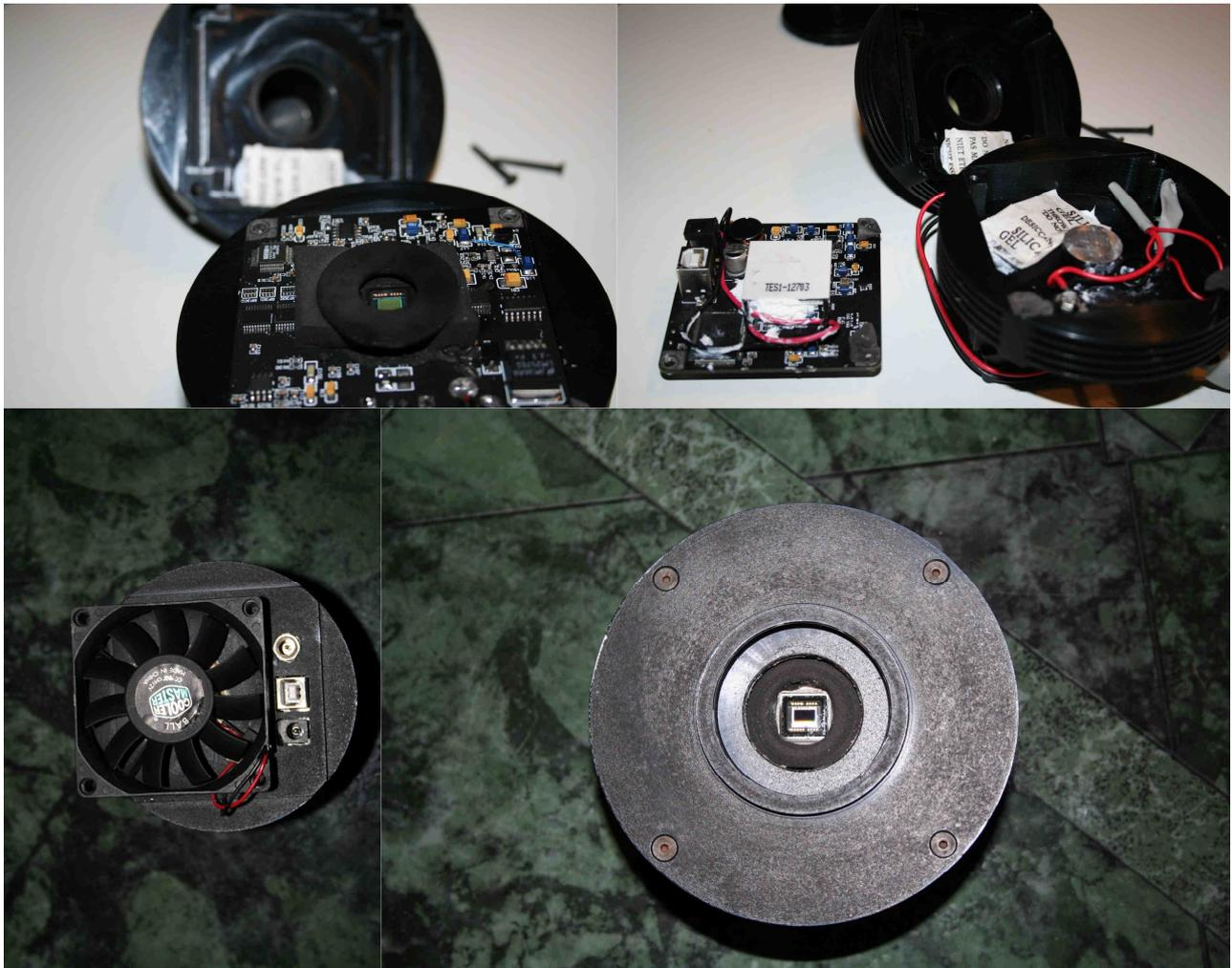
**Figura 1.** Modificaciones realizadas por el autor sobre la cámara Orion DSSI. El chip en color original de la cámara (ICX 259AK) se sustituyó por el monocromo ICX 259AK, con el mismo patillaje y características. El tamaño de píxel es de 6,5x6,25 micras. El sistema de refrigeración añadido consiste en una célula Peltier de buen tamaño a 12 voltios y un ventilador de PC en la parte posterior.
