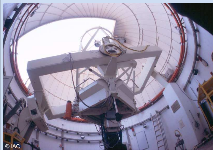
Cámara FASTCAM acoplada al telescopio Carlos Sánchez, en el Observatorio del Teide. Esta cámara es propiedad del Instituto de Astrofísica de Canarias (IAC). El dispositivo utiliza la técnica de alta resolución llamada Lucky Imaging . Con esta cámara, un equipo de astrofísicos españoles observaron la binaria de enanas marrones HD 130948 BC.
